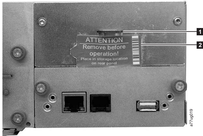
Figure 10-2. Emplacement de la clé et de l'étiquette de verrouillage
