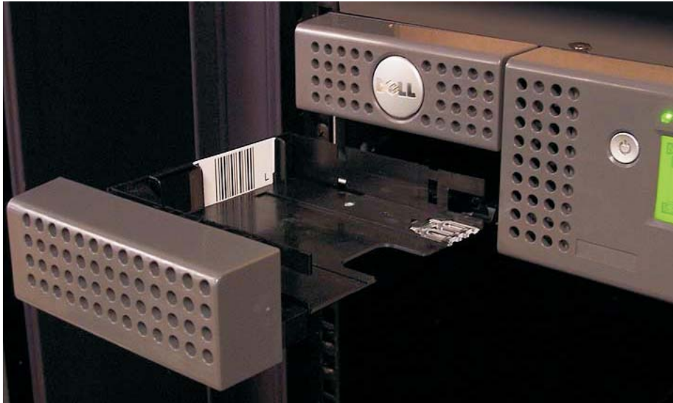
Figure 4-41. Guichet d'E/S du magasin gauche de la bandothèque 2U
