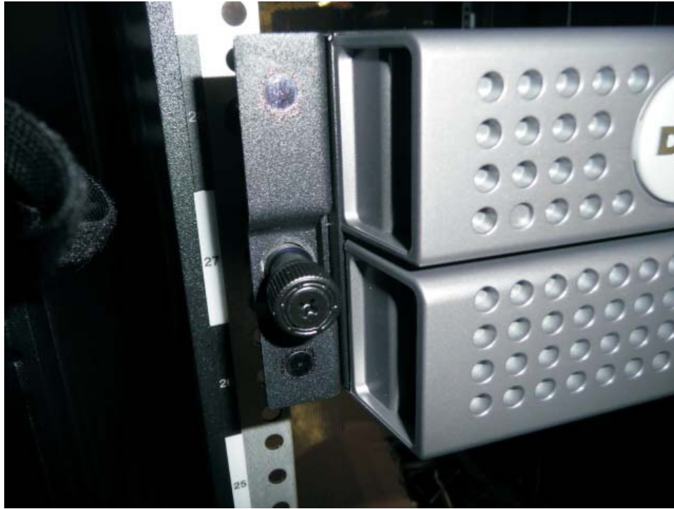
Figure 4-14. Vis latérales de la bandothèque 2U, à retirer
