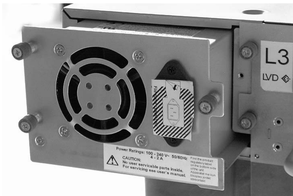
Figure 10-10. Retrait d'un bloc d'alimentation électrique d'une bandothèque 2U
