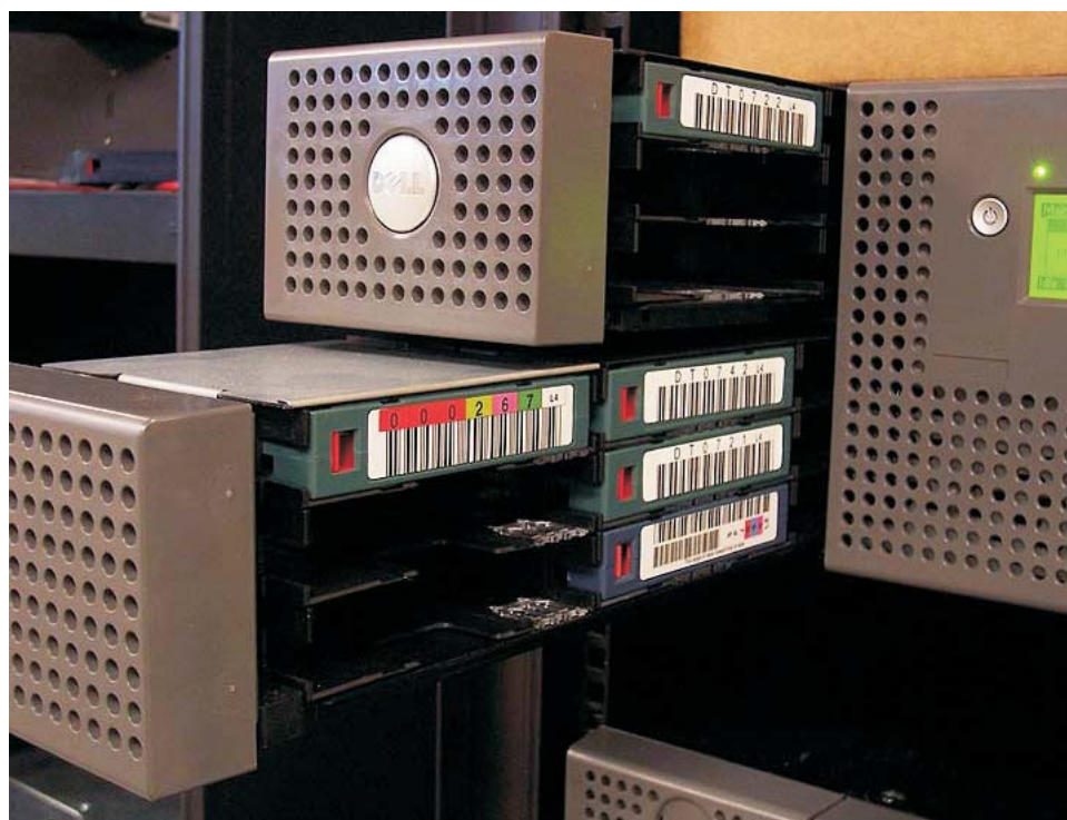
Figure 4-44. Guichet d'E/S du magasin inférieur gauche de la bandothèque 4U
