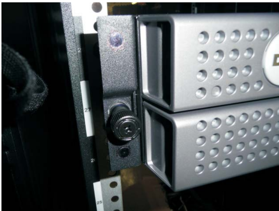
Figure 4-15. Insertion de la bandothèque 2U dans l'armoire
