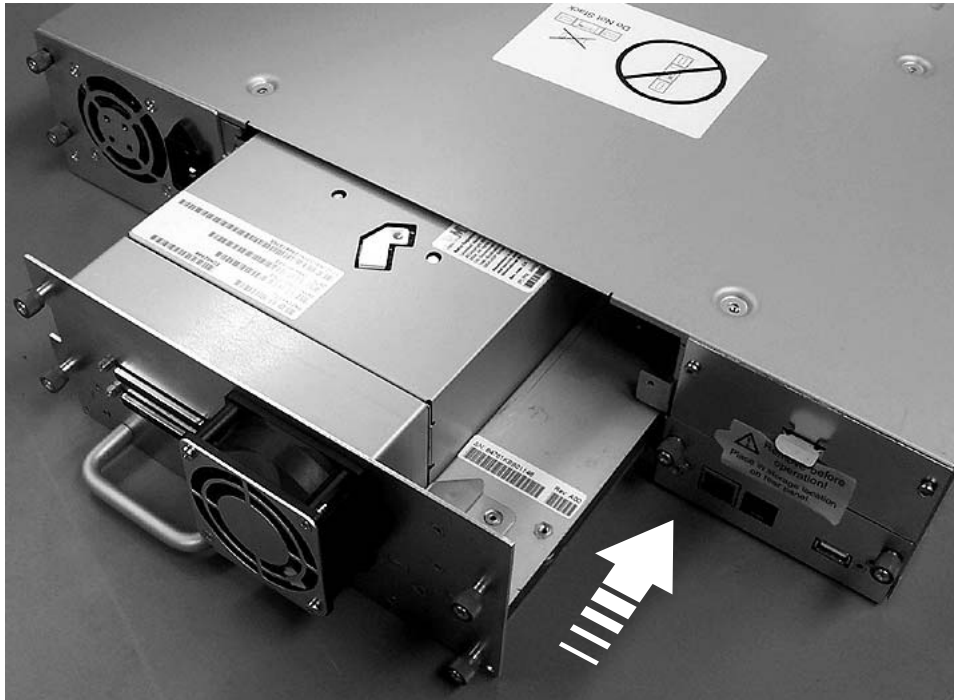
Figure 10-8. Insertion de la glissière d'unité dans la bandothèque (glissière d'unité sans ressorts ESD)
