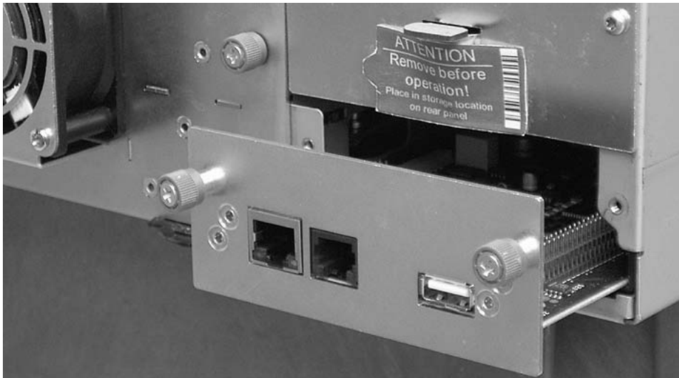
Figure 10-19. Retrait d'une carte contrôleur de la bandothèque
