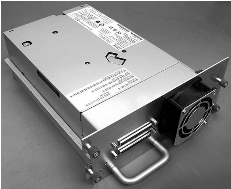
Figure 1-6. Glissière d'unité de la bandothèque sans ressorts ESD (glissière SCSI)
