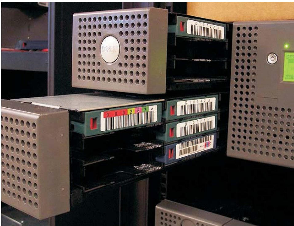
Figure 9-4. Magasins de gauche retirés de la bandothèque 4U
