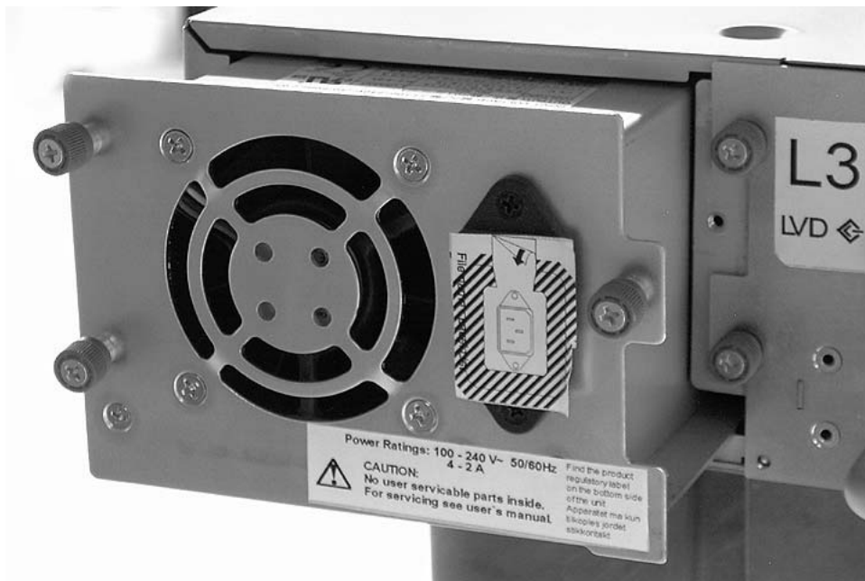
Figure 10-18. Bloc d'alimentation électrique retiré d'une bandothèque
