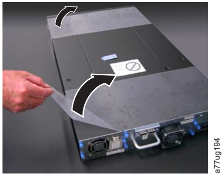
Figure 4-1. Retrait des couches de protection en plastique de la bandothèque
