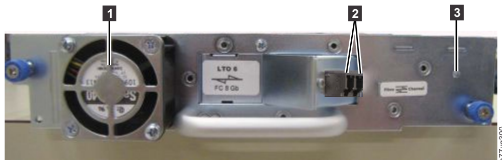
Figure 1-3. Panneau arrière (glissière d'unité uniquement) d'une unité Fibre Channel hauteur
