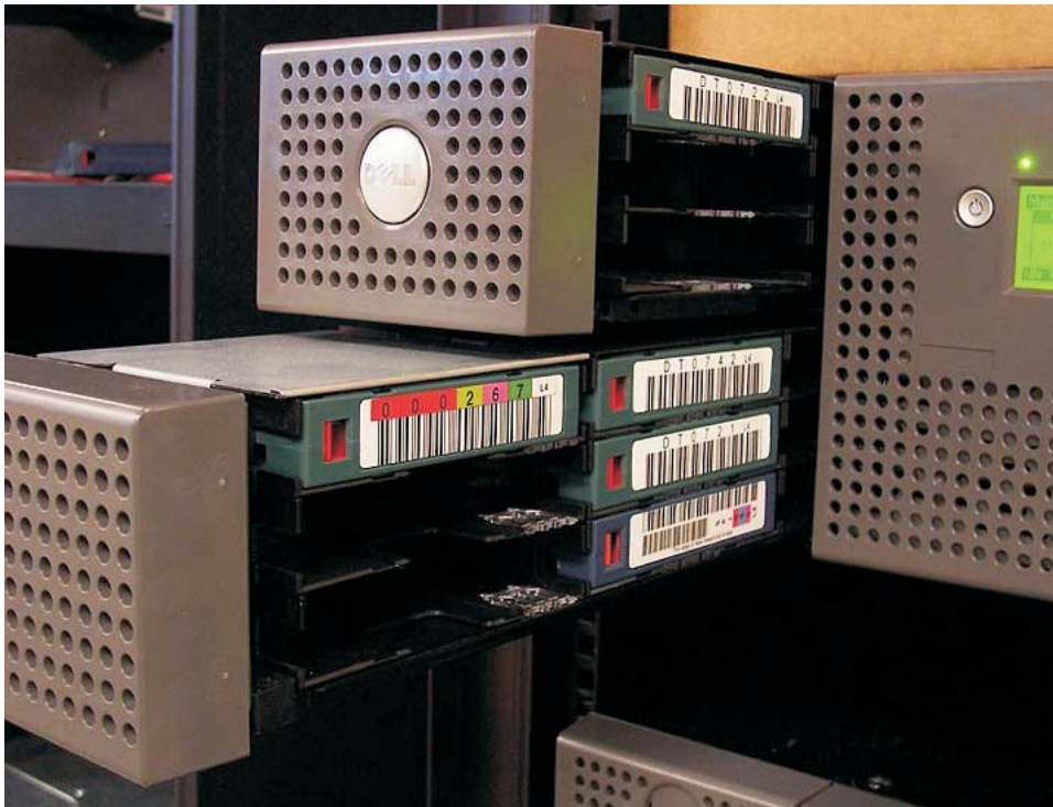
Figure 10-23. Magasins de gauche retirés de la bandothèque 4U (face avant de la bandothèque)
