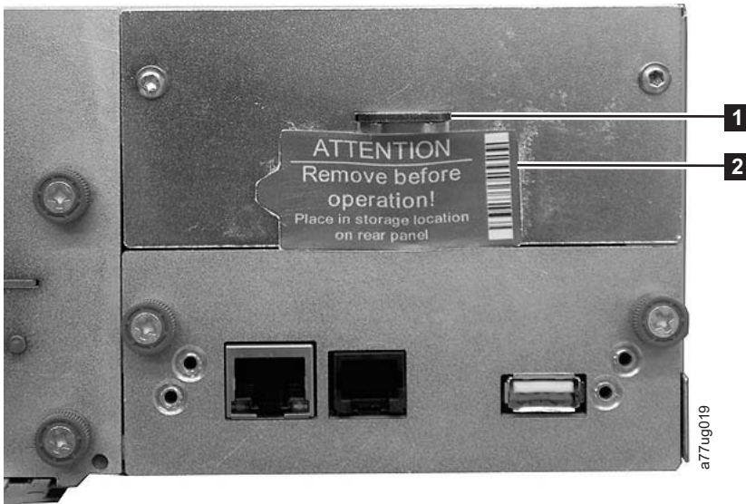
Figure 10-15. Emplacement de stockage de la clé de verrouillage et de son étiquette sur le panneau arrière de la bandothèque
